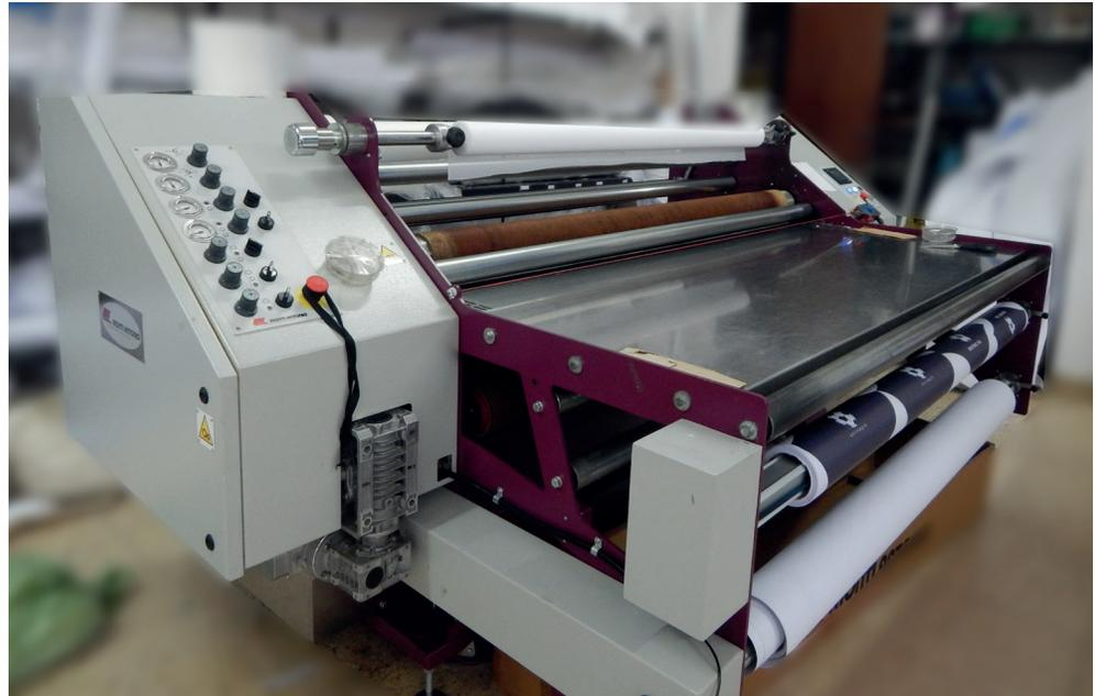
Calandra: máquina de rodillos sublimadora de telas de poliéster en rollo.
