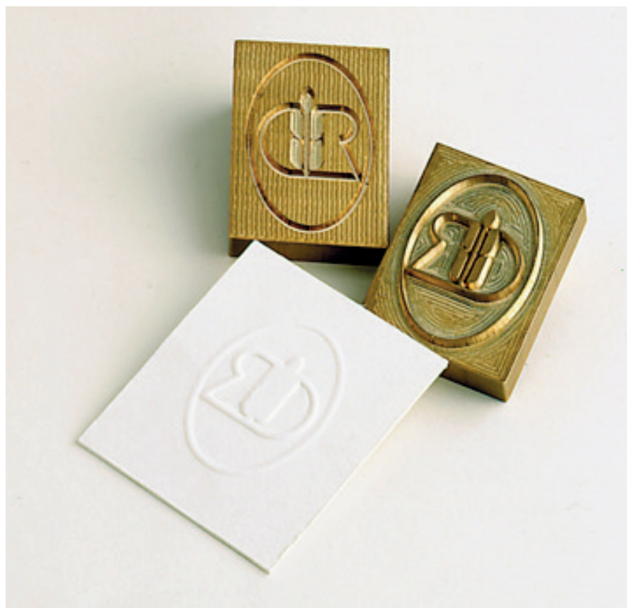
Ciisé (o cuño) macho/hembra para timbrado o gofrado
