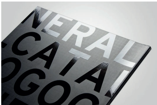
Laca sectorizada aplicada sobre laminado polipropileno mate.
