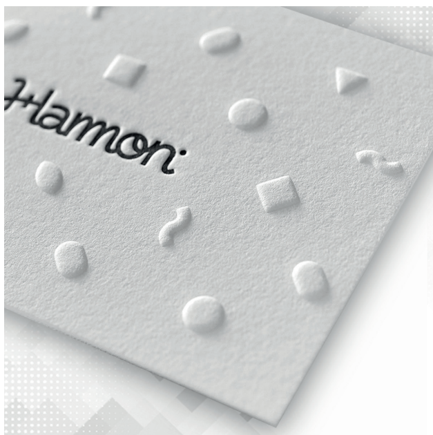
Timbrado contrarrelieve y cuño en seco (gofrado)
